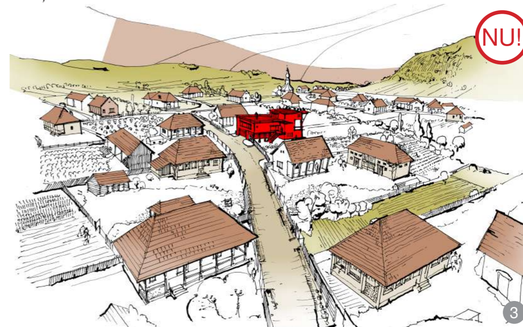
AȘA NU: Este interzisă construirea de clădiri cu acoperiș terasă și cu un limbaj arhitectural ce nu respectă specificul local rural și care seamănă mai degrabă cu vile urbane.
