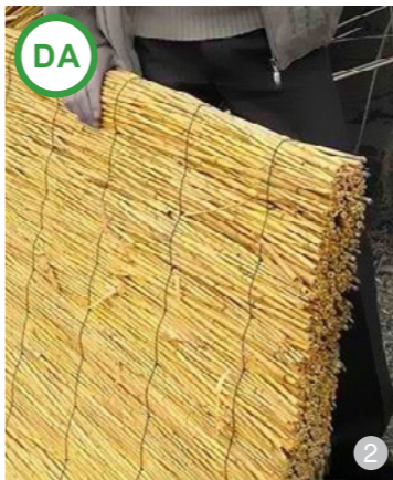
AȘA DA: Exemple de pereți placați cu panouri termoizolante de stuf
