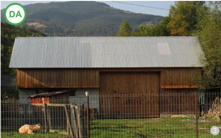
ASA DA: Se observă păstrarea specificului local în construcția șurilor din zona Bârgăului. În cazul de față, se recomandă înlocuirea tablei de pe acoperiș cu țigla sau șită și evitarea folosirii BCA-ului ca material de construcție (imagine din zona Bârgău).
