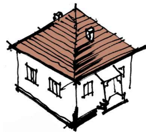
Proiecte de tip modernist „case-bloc”, cum li se spune „la țară”. Au șarpante pe scaune cu cosoroabe și căpriori care ies peste zid – au streșini înfundate cu podine de scânduri uniforme.
