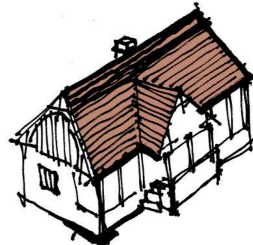
„Friguria” perpendiculară pe volumul acoperișului o considerăm o rezolvare acceptabilă a dezvoltării naturale a târnațului în vederea protejării intrării, accesului la demisol și a ocupării podului cu spațiu de locuit.
