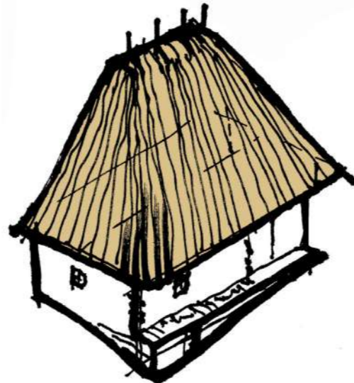
Acoperiș în patru ape din paie (cu șarpante specifice) cu pantă peste 60° – poate reda specificul local pierdut în zona Meseș după anii '50.
