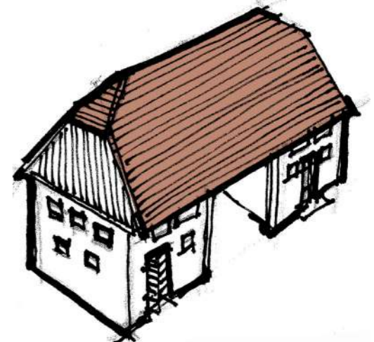
Lăzi din zidărie la șuri cu acoperișul în două ape semiteșit la frontoane.
