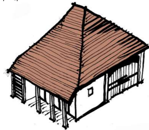
Șură pe tălpi din Dragu cu acoperiș din paie semiteșit, cu căpriori și tălpi curbe ce stau pe „perini”.
