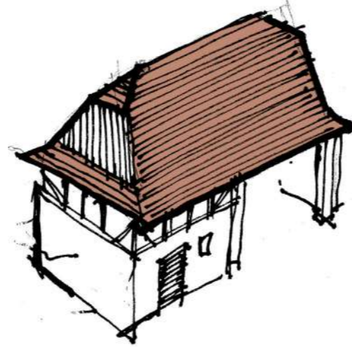
Șuri cu acoperiș în două ape semiteșite și cu aruncătoare largi – le întâlnim spre zona Ciucea și Călata.
