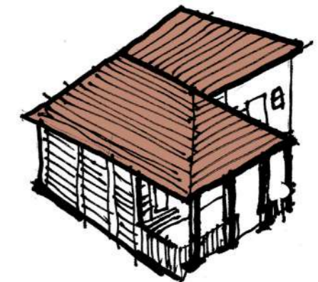
Anexe, găbănașe în forme diverse, de obicei în două sau patru ape, unite sau nu cu „cohea” sau chiar cu șura. De multe ori, au și ele un pridvor asemănător casei.
