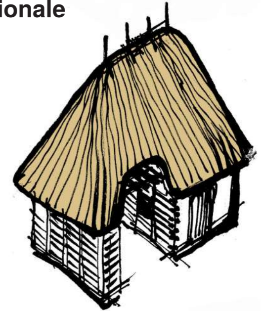
Șuri cu gârbe cu acoperișuri din paie în patru ape, cu șarpante specifice de o mare inventivitate în folosirea lemnului.
