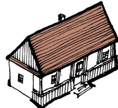
Acoperiș în două ape cu pereții laterali protejați de două rânduri de cirpuri (detaliu denumit „împroșcător” sau „aruncător de apă”) – întâlnit rar înspre Cluj și înspre zona etnografică Sălaj.
