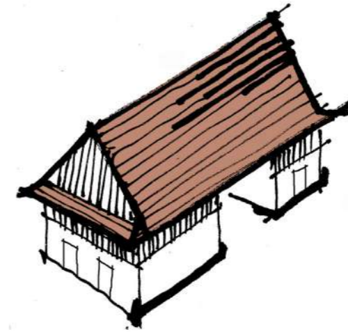
Șuri cu ladă cu acoperișul cu aruncătoare ce protejează lateralele sau unele anexe. „Fundurile” podului sunt drepte.
