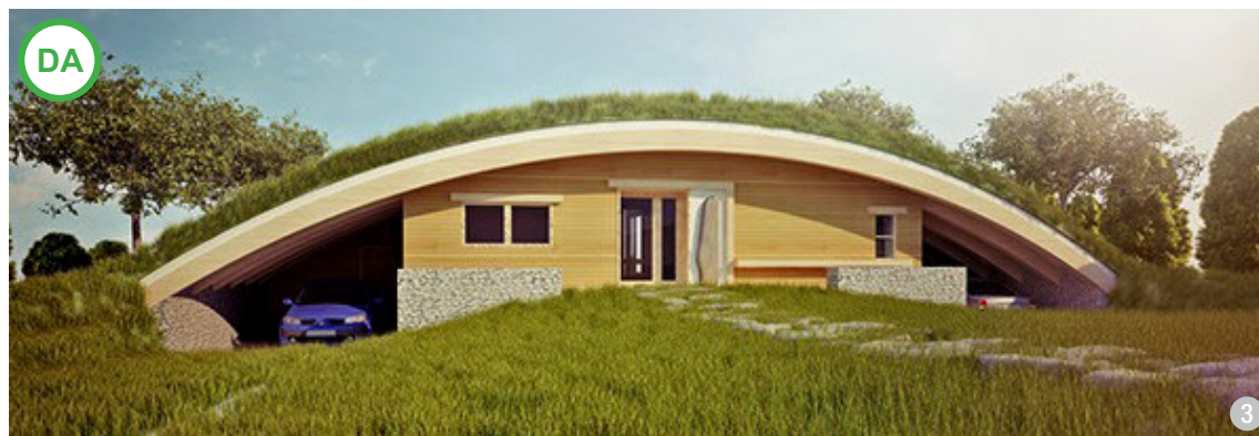
AȘA DA: Integrarea în peisajul caracterizat de dealuri molcome, a unei construcții semi-îngropate, prin volumetria acoperișului și înierbarea lui.
