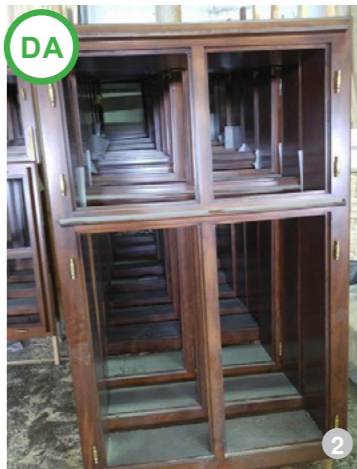
ASA DA: Pentru clădiri vechi fără valoare istorică mare, se poate recurge la soluția unei ferestre din lemn cu croi tradițional, cu un singur rând de geamuri multistrat: cunoscutele ferestre de tip termopan.
