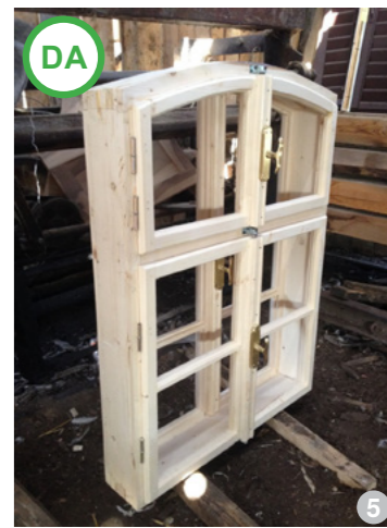
ASA DA: Atunci când fereastra nu mai poate fi salvată, se poate recurge la serviciile unui atelier local de tâmplărie, pentru a reproduce fereastra după croiul original.
