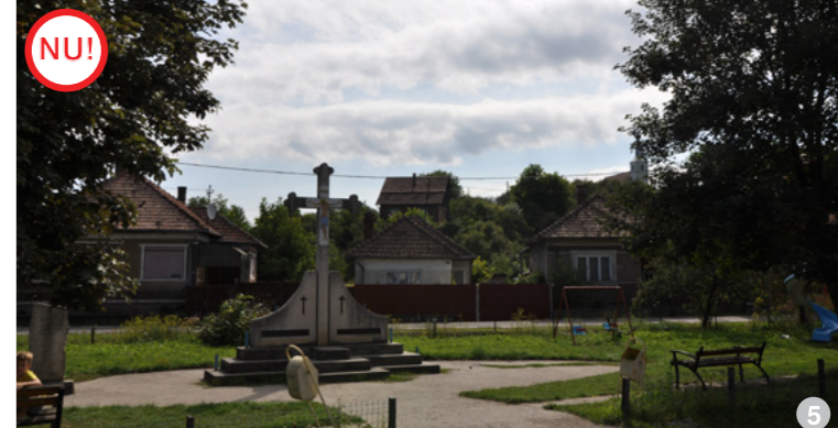
ASA NU: Se vor evita amenajările de spații verzi împrejmuite cu garduri din fier, cu alei pavate cu pavele de beton sau beton turnat și mobilate neadecvat specificului tradițional (imagine din satul Aghireșu).
